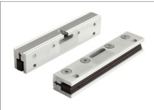
Der Klemmbeschlag „Syno 80“ für Ganzglas-Schiebetürblätter ist ein hochwertiger Alu-Beschlag, der für Glasblätter bis 80 kg eingesetzt werden kann. Die ESG-Gläser in 8 oder 10 mm Stärke können ohne Ausnehmungen gefertigt werden. Die geringe Baugröße von B 18 x H 3,5 cm ist vorteilhaft und macht dieses Zubehör zu einem systemkonformen Hängebeschlag. Die Zuschnitthöhen, bzw. Abzugsmaße fordern Sie bitte unter [info@eclisse.de](mailto:info@eclisse.de) an.
