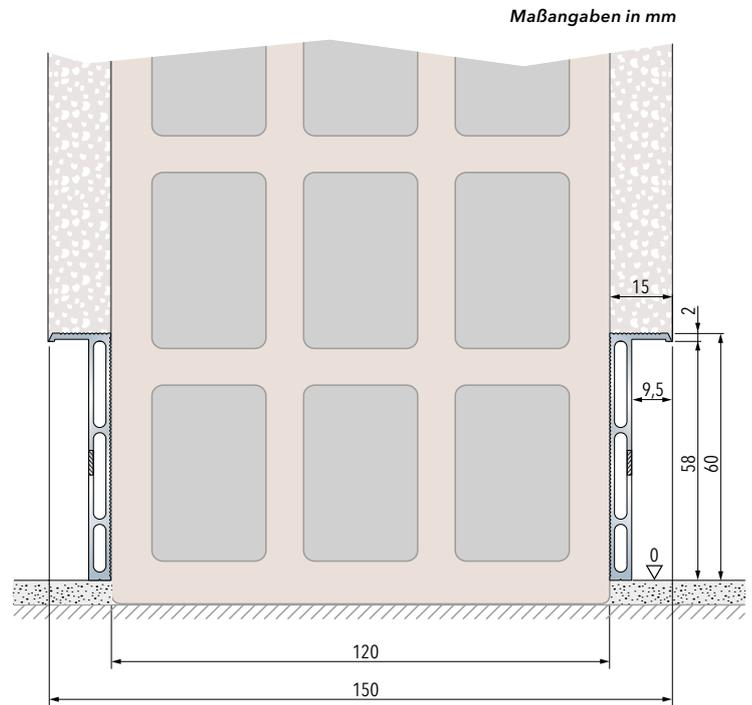
Auf gemauerten Wänden installierte Fußleiste
