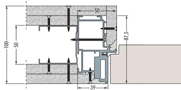
Trockenbauwand, Profil 75 oder 100, zweimal belegt (GKB 12.5)
