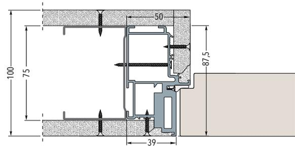
Trockenbauwand, Profil 50, zweimal belegt (GKB 12.5)
