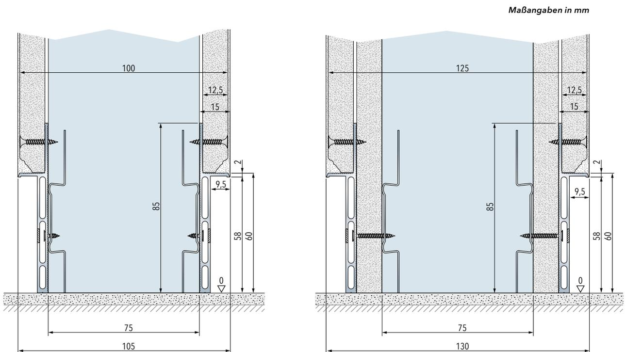
Auf Gipskartonwänden installierte Fußleiste
