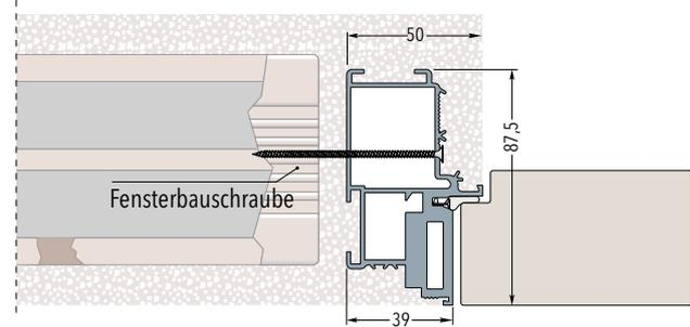
Trockenbauwand, Profil 75, einmal belegt (GKB 12.5)
