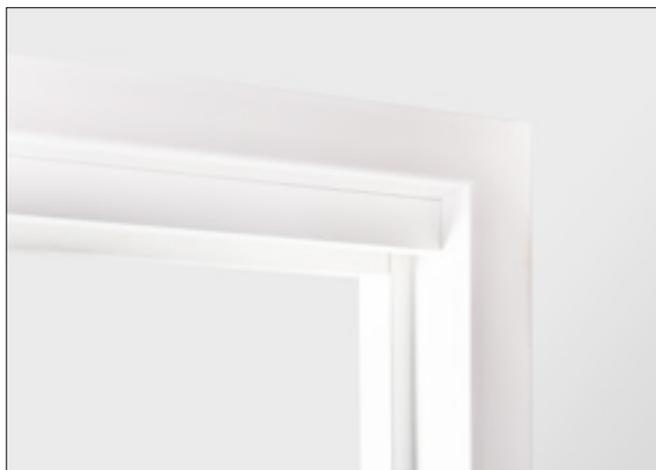
Diese Stahlzarge ist zweischalig ausgeführt, und sehr einfach zu montieren. Die Zarge hat einen Spiegel von ca. 4 cm, wobei die Eckverbindungen bereits verschweißt und geschliffen sind. Die Oberflächen sind grundiert, und damit als Malgrund vorbereitet.
