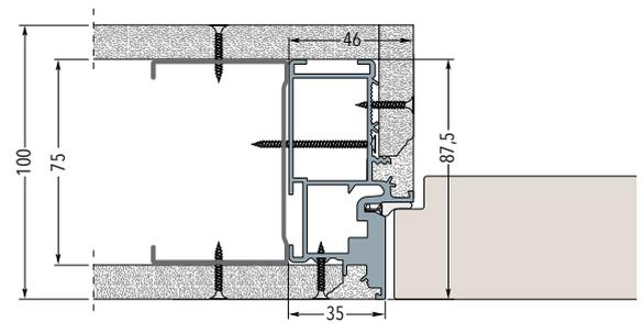
Trockenbauwand, Profil 50, zweimal belegt (GKB 12.5)
