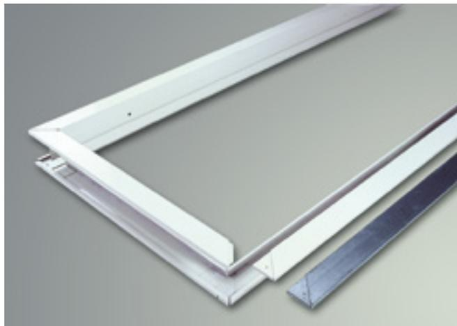
Unsere geteilten Stahlzargen für Schiebetürkästen sind sehr stoßfest und erhöhen die Stabilität der gesamten Türkonstruktion. Die Materialstärke ist robust in 1,2 mm Stahlblech ausgeführt, und haben einen Spiegel von ca. 7 cm. Die verzinkten Oberflächen werden bauseitig in der gewünschten Farbe gestrichen. Die oberen Querstücke sind auf Gehrung geschnitten, und können so auch nachträglich ausgebaut werden.
