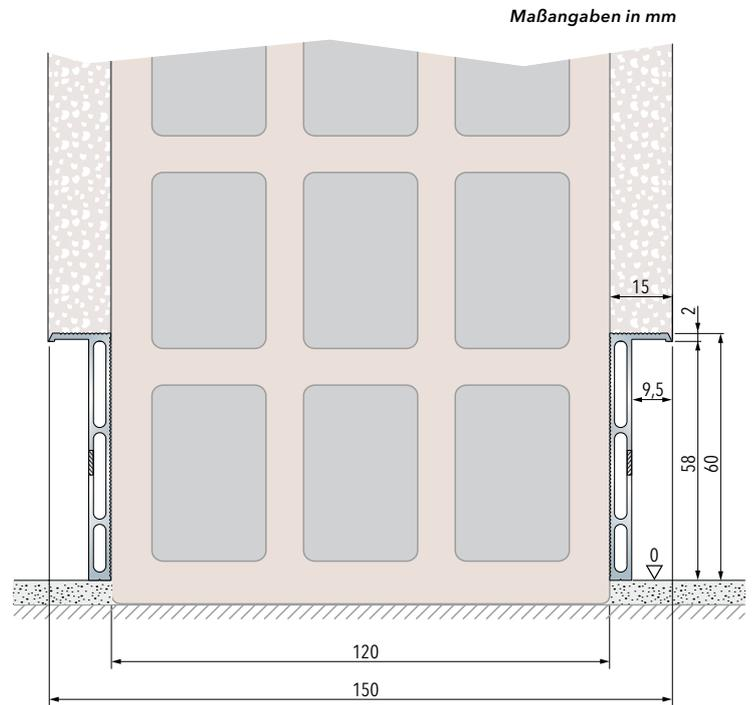
Auf gemauerten Wänden installierte Fußleiste
