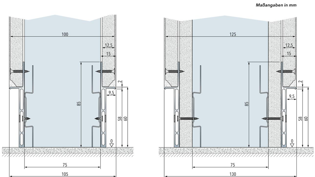
Auf Gipskartonwänden installierte Fußleiste
