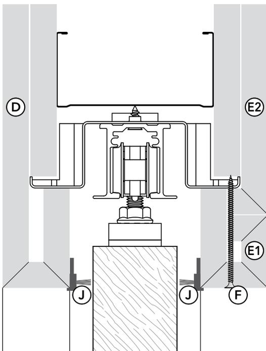
Vertikalschnitt mit Glastürblatt
