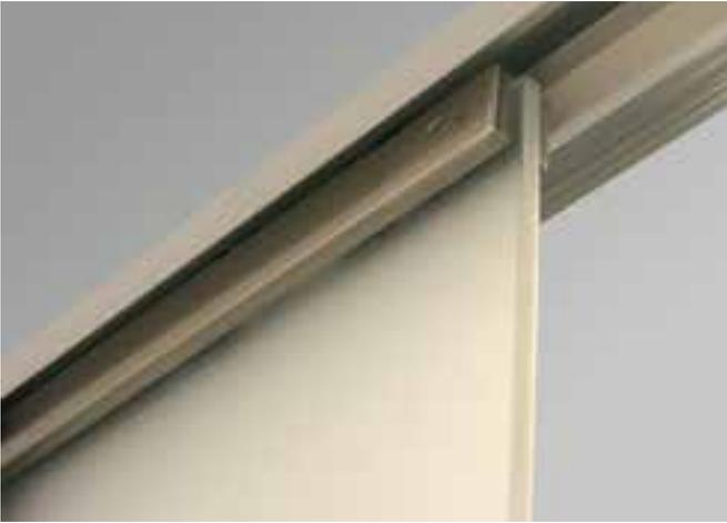
Das Umrüst-Set VITRO+ für Ganzglas-Schiebetürblätter im Modell ECLISSE SYNTESIS® LINE besteht aus Klemmbeschlägen (keine Ausnehmungen im Glas erforderlich), dezenten Abdeckblenden, einer weiß folierten Anschlagplatte, Bürstendichtungen für die Verschmälerung des Einschubes und einer geräuscharmen Bodenführung. Das Set VITRO+ kommt für Gläser bis 80 kg (Stärke 8 oder 10 mm) und bis max. Breite 120 cm zum Einsatz.
