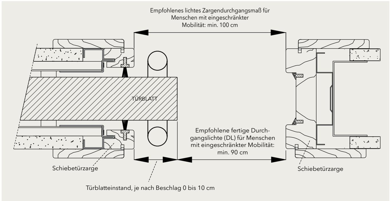
Die ECLISSE-Schiebetürkästen sind so konstruiert, dass ein glattes Türblatt ohne auskragenden Griff (z.B. Stangengriff) komplett eingeschoben werden kann.
