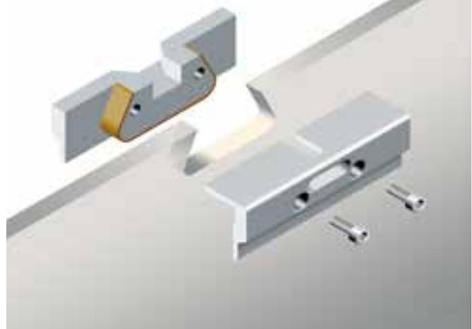
Der Eclisse Einsetzbeschlag ist trotz seiner geringen Bauhöhe von 35 mm für Glastürblattgewichte bis 100 kg ausgelegt. Die Fertigung erfolgt in hochwertigem Alu-Druckguss, mit veredelten Oberflächen.
