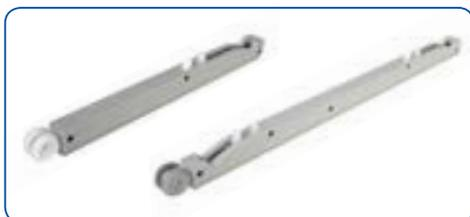
Die Einzugsdämpfer ECLISSE BIAS® und ECLISSE BIAS® DS werden vorteilhaft in der Laufschiene geführt und können jederzeit, auch bei eingebautem Türblatt, justiert werden. ECLISSE BIAS® bremst und zieht Türblätter bis 40 kg in der Schließbewegung an das Anschlagprofil. ECLISSE BIAS® DS hat zusätzlich noch eine Bremsfunktion auf den letzten Zentimetern bei der Öffnungsbewegung des Türblattes.
