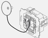
3. Stecken Sie das Kabel in die Anschlussklemme.
