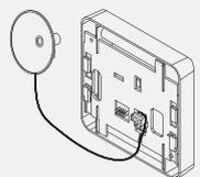
3. Stecken Sie das Kabel in die Anschlussklemme.
