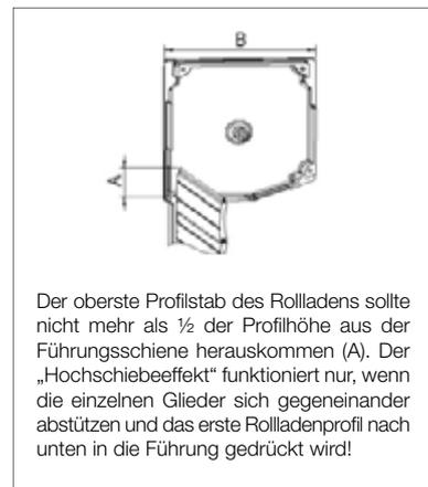
Der oberste Profilstab des Rollladens sollte nicht mehr als  $\frac{1}{2}$  der Profilhöhe aus der Führungsschiene herauskommen (A). Der „Hochschiebeeffect“ funktioniert nur, wenn die einzelnen Glieder sich gegeneinander abstützen und das erste Rollladenprofil nach unten in die Führung gedrückt wird!
