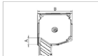
Der oberste Profilstab des Rolladens sollte nicht mehr als 1/2 der Profilhöhe aus der Führungsschiene herauskommen (A). Der „Hochschiebeeffekt“ funktioniert nur, wenn die einzelnen Glieder sich gegeneinander abstützen und das erste Rolladenprofil nach unten in die Führung gedrückt wird!
