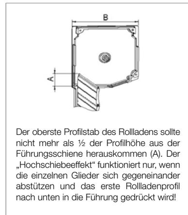
Der oberste Profilstab des Rolladens sollte nicht mehr als 1/2 der Profilhöhe aus der Führungsschiene herauskommen (A). Der „Hochschiebeeffekt“ funktioniert nur, wenn die einzelnen Glieder sich gegeneinander abstützen und das erste Rolladenprofil nach unten in die Führung gedrückt wird!
