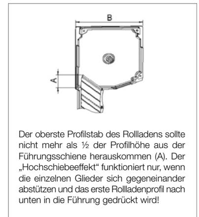
Der oberste Profilstab des Rollladens sollte nicht mehr als 1/2 der Profilhöhe aus der Führungsschiene herauskommen (A). Der „Hochschiebeeffect“ funktioniert nur, wenn die einzelnen Glieder sich gegeneinander abstützen und das erste Rollladenprofil nach unten in die Führung gedrückt wird!
