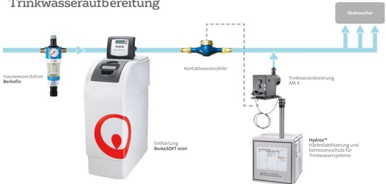
Beispielinstallation einer Trinkwasseraufbereitung mit Schutzfilter, Teilenthärtung und Dosierung zur Resthärtestabilisierung zum Korrosionsschutz.
