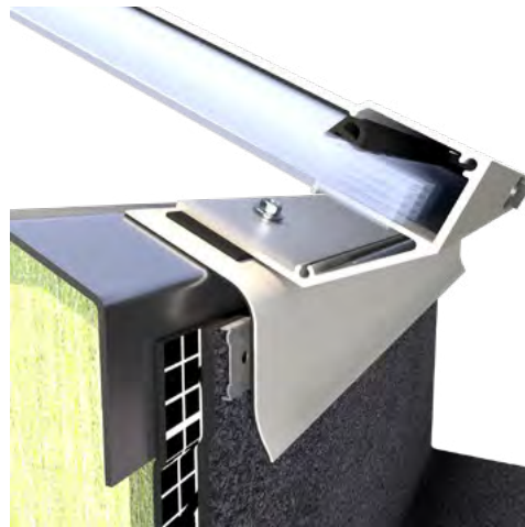
Bitumenanschluss, 2-lagig, an Anschlussblech mit Kappleiste. Schutz der oberen Anschlussfuge durch eingeklemmten Schleppstreifen (z.B. FPÖ)
