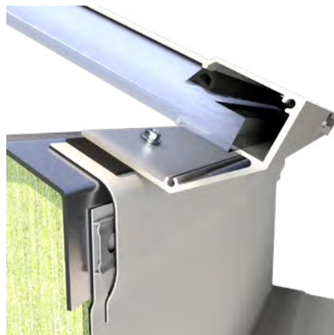
Folienanschluss, 1-lagig, an Anschlussblech mit Kappleiste. Schutz der oberen Anschlussfuge durch eingeklemmten Schleppstreifen (z.B. FPÖ)
