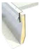
Stahl-Aufsetzkranz U_{up} -Wert: 1,7 W/m 2 K (30 cm) U_{up} -Wert: 1,3 W/m 2 K (50 cm) U_{up} -Wert: 1,1 W/m 2 K (70 cm)
