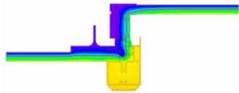
**Isothermenverlauf Einzelklappe esserlux® therm:**
