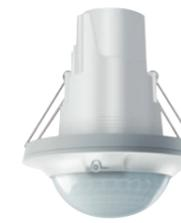
Deckeneinbau-Version: Einfache Montage mit Standard-Bohrkrone (Ø 68 mm)
