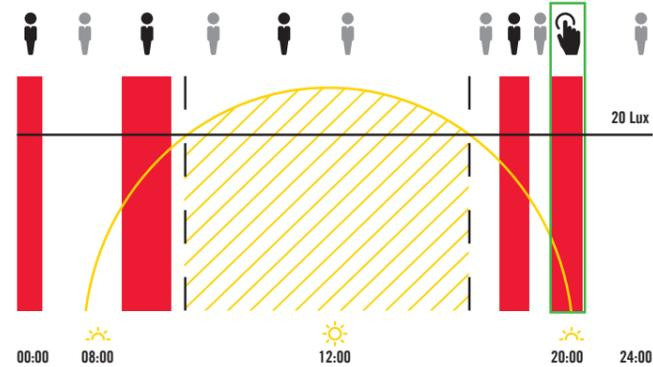
Ein 200°-Bewegungsmelder ist an der Fassade eines Einfamilienhauses installiert. Im Betriebsmodus Vollautomatik schaltet er das Licht bewegungs- und tageslichtabhängig. Per Taster kann der Endanwender die Beleuchtung von innen auch manuell einschalten.
