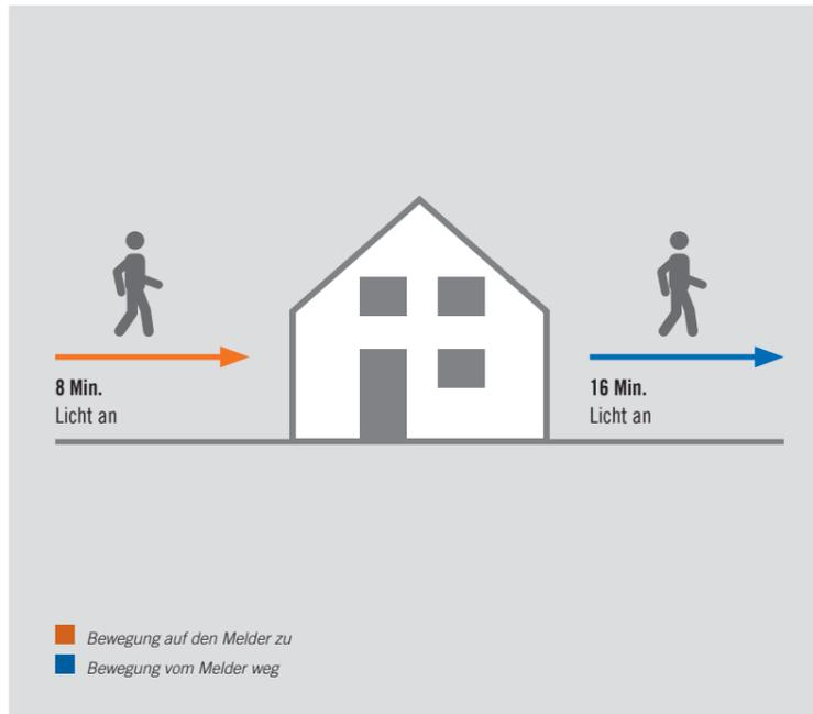
Ein 230°-Bewegungsmelder ist oberhalb eines Türbereichs montiert. Betritt jemand das Haus und geht auf den Melder zu, endet die Nachlaufzeit schon nach energiesparenden 8 Minuten. Bei umgekehrter Gehrichtung lässt die Nachlaufzeit das Licht noch 16 Minuten scheinen und schafft so Sicherheit durch einen beleuchteten Außenbereich.
