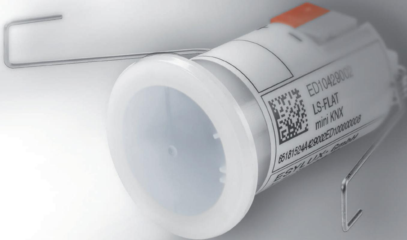
Der Helligkeitsregler LS-FLAT mini KNX verhilft jeder KNX-Beleuchtungssteuerung zu mehr Individualität, Flexibilität und Energieeffizienz. Verborgен im winzigen Gehäuse schaltet, regelt oder steuert er auf Basis seiner Lichtmessung zwei separate Lichtkanäle. Er kann zwei externe Lichtwerte mit dem eigenen verrechnen, wodurch sich nahezu unbegrenzte Möglichkeiten zur Mehrpunktmessung und Kaskadierung ergeben.
