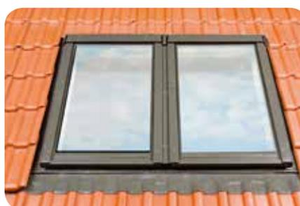
Mit den FAKRO Kombi-Eindeckrahmen lassen sich Fenster fast beliebig nebeneinander, übereinander oder als Block in die Dachfläche einbauen. Bei der Standardanordnung beträgt der Abstand zwischen den nebeneinander und übereinander angeordneten Fenstern 10 cm. Das Kombi-System besteht aus sieben Modulen, mit denen nahezu jede Kombination realisiert werden kann.
