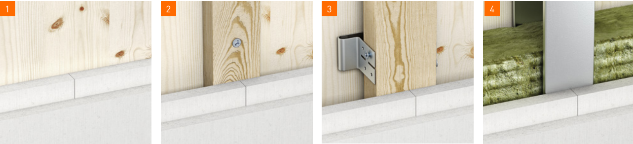
1 Direkt Beplankung auf Massivholz/ Brettsperrholz (alternativ Holzwerkstoffplatten)
