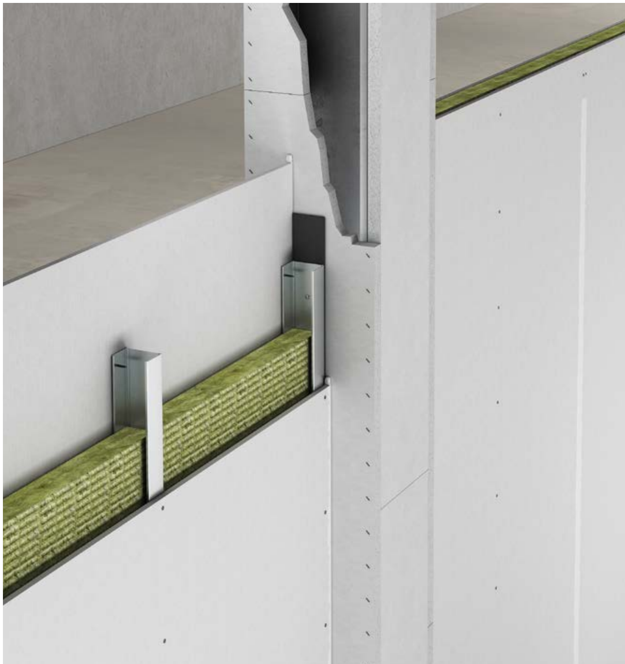
Detaillösungen Anschluss Trockenbauwand an bekleidete Stahlstützen
