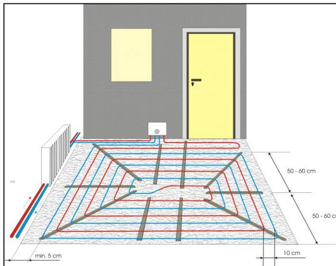
FLEXIRO Dünnbett Fußbodenheizung, Verlegeform: spiralförmig
