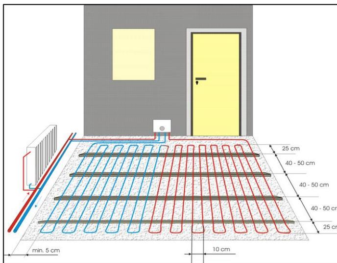
FLEXIRO Dünnbett Fußbodenheizung, Verlegeform: mäanderförmig
