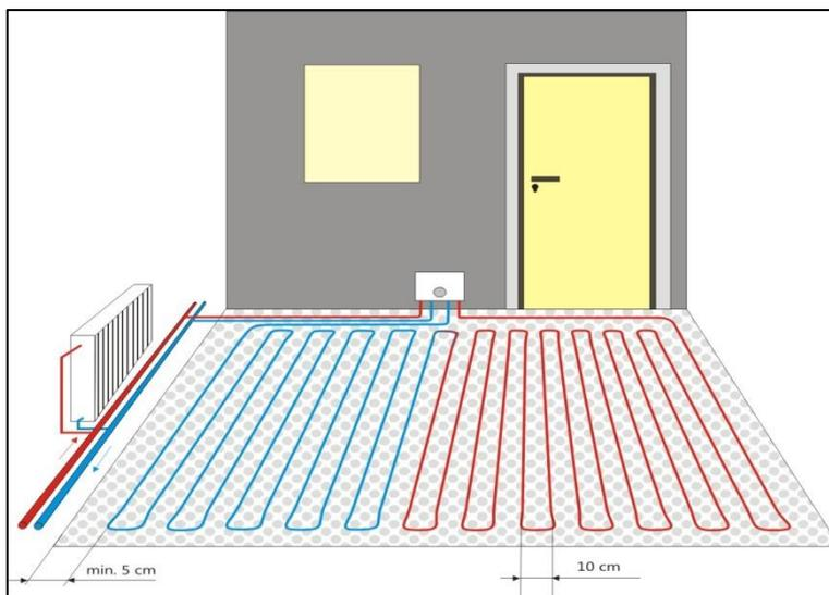
FLEXIRO Dünnbett Fußbodenheizung, Verlegeform: mäandrierförmig; Aufgrund der zahlreichen, engen Radien empfiehlt sich die Verwendung von Niederhaltern.
