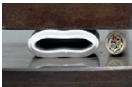
Verformung 50 % „biegsam, sich selbst zurückbildend“
