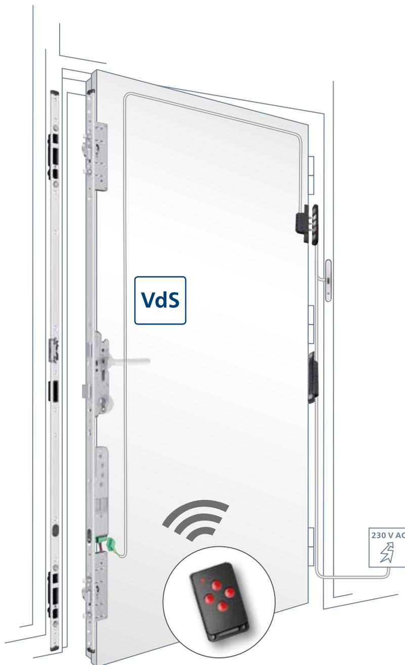
Die Standardausführung beinhaltet alle Systemkomponenten anschlussfertig in einem Set. Die Tür wird bauseits nur noch an die vorhandene 230-V-Leitung angeschlossen.
