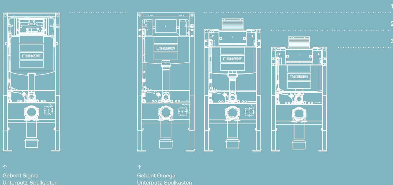
1 Bauhöhe 112 cm. 2 Bauhöhe 98 cm. 3 Bauhöhe 82 cm.
