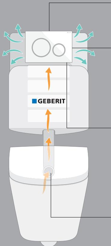
Keramikwabenfilter und Einschub für Spülkastensticks sind hinter der Betätigungsplatte bequem zugänglich.
