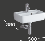
HANDWASCHBECKEN B 500 / T 380 Mit Hahnloch rechts, mit Überlauf 272150000 Ohne Hahnloch, mit Überlauf 272153000 Ohne Hahnloch, ohne Überlauf 272151000 Mit Hahnloch rechts, ohne Überlauf 272152000
