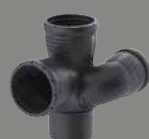
GEBERIT SILENT-PRO SCHACHTBOGENABZWEIG 87,5° links, DN 90 / 70 / 90 – DN 100 / 70 / 100
