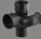
GEBERIT SILENT-PP SCHACHTBOGENABZWEIG 87,5° links, DN 90 / 70 / 90 – DN 100 / 70 / 100
