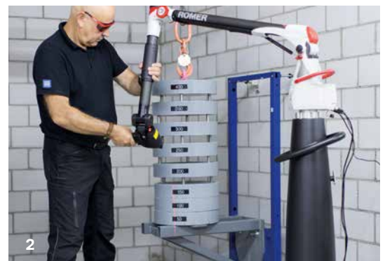
1 Geberit Duofix Montageelement für höhenverstellbares WC. 2 Im Geberit Labor getestet auf hohe und normgerechte Belastungen.
