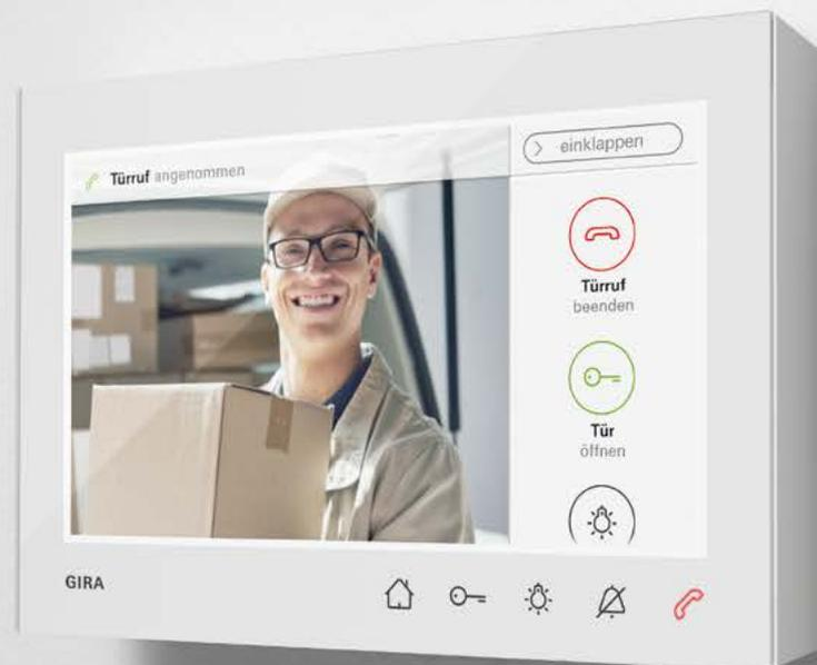
Die Bedienung erfolgt über das vollflächige Touchdisplay. Zusätzlich lassen sich Grundfunktionen wie Türruf annehmen, Licht einschalten oder Klingel stummschalten über die fünf Schnellwahltasten am unteren Bildschirmrand bedienen.
