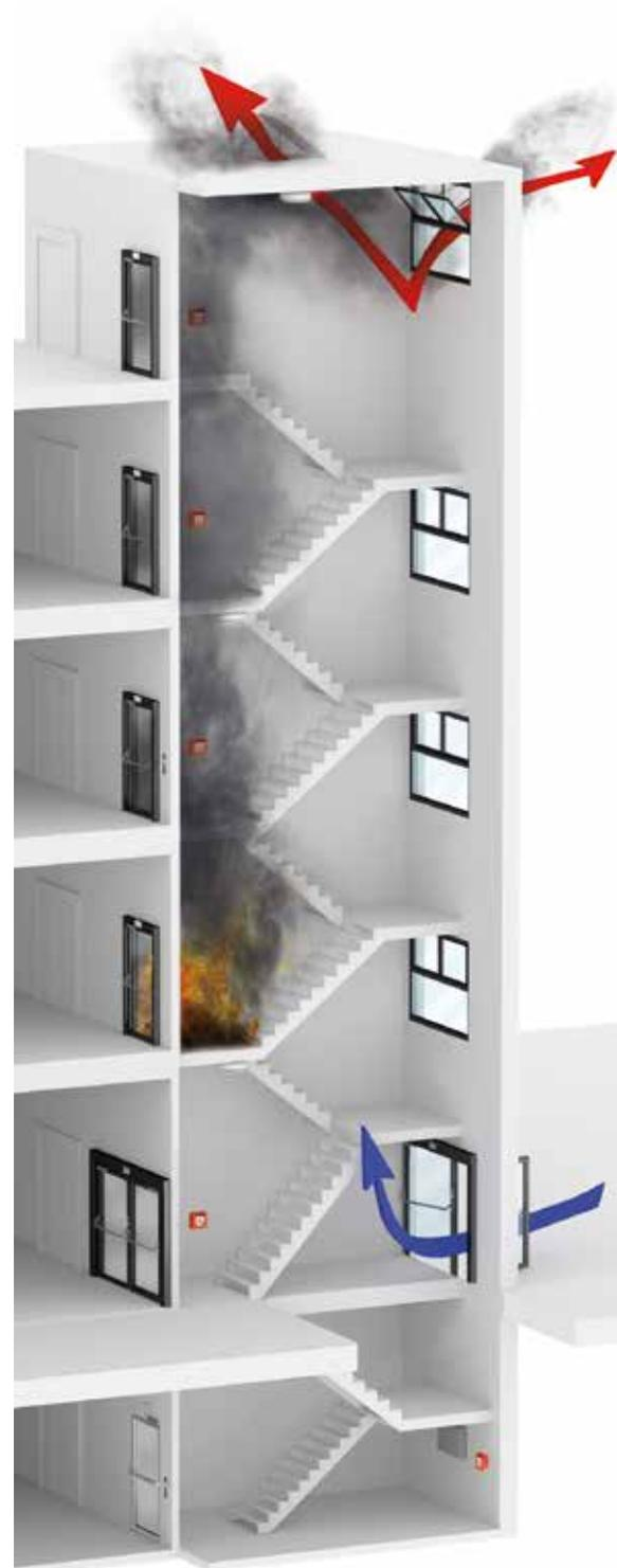
Schematische Darstellung der Funktionsweise einer RWA-Anlage mit Zuluft-, Dachfenster- und Fassadenöffnung
