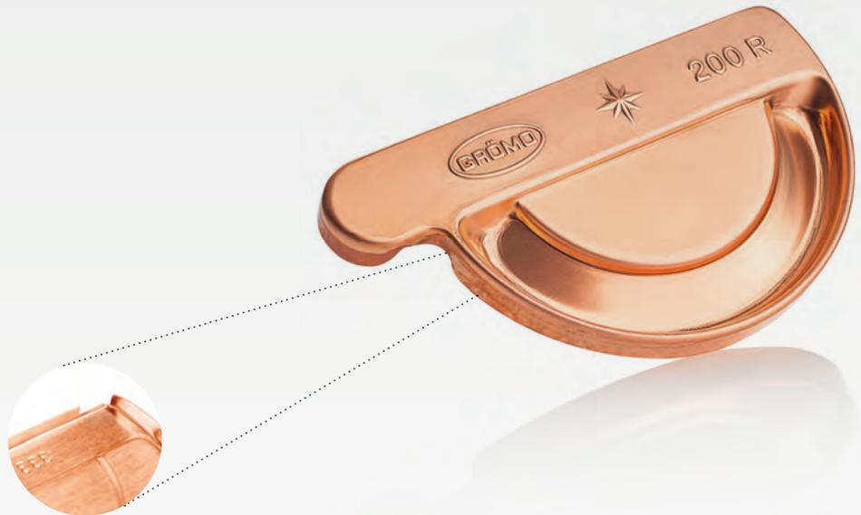
Mit dem GRÖMO Stechrinnenboden geht es schneller, sauberer und einfacher. Dank Einstecknut lässt er sich einfach an die Dachrinne stecken und hält von selbst. Sie haben freie Hand zum Löten oder Kleben. Ein Wegspringen – wie es bei anderen Löt-rinnenböden möglich ist – wird durch die Einstecknut verhindert.
