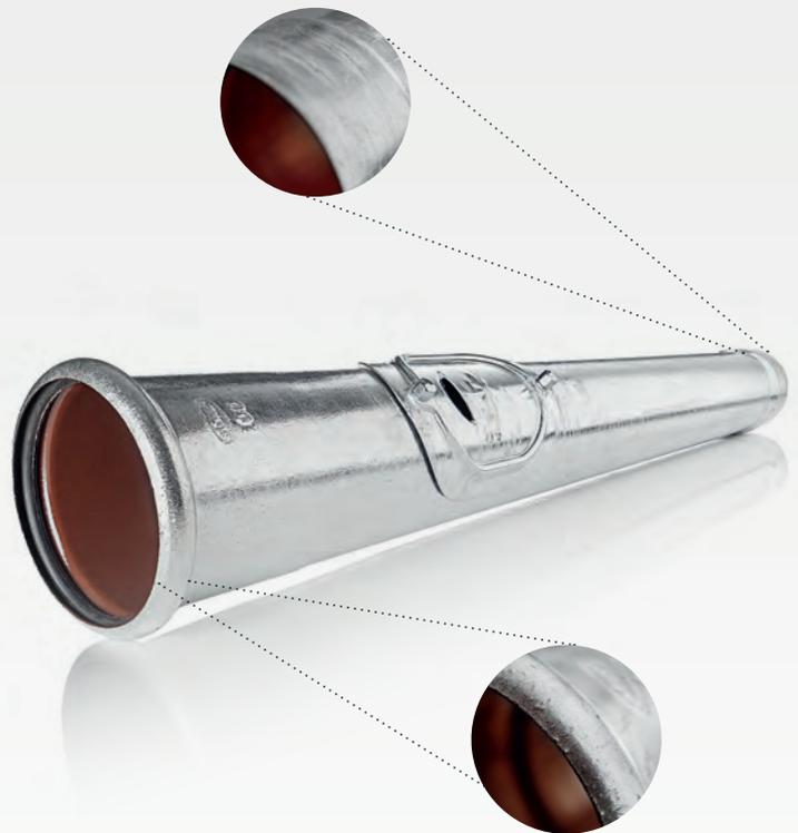
Das GRÖMO Regenstandrohr sorgt für fließende Übergänge. Als fester Bestandteil in der Dachentwässerung schützt das Standrohr vor Beschädigungen im stoßanfälligen Bereich. Besonders schlau: Der passgenaue Übergang vom Regenfallrohr zum Standrohr macht eine Standrohrkappe überflüssig. Die eingebaute Dichtung sorgt für Halt und optimale Zentrierung der beiden Rohre. Dank der großen Reinigungsöffnung des Standrohrs (optional) entsteht mehr Bewegungsfreiheit für das Säubern.
