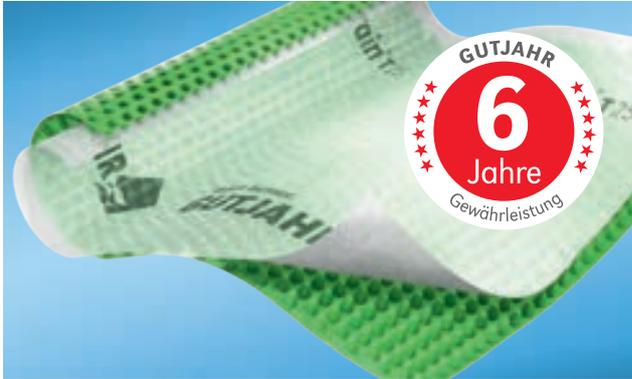
Sehr häufig stößt man bei (Dach-)Terrassen auf die Situation, dass ein geringes oder kein Gefälle auf der Abdichtung vorhanden ist. Das Wasser sammelt sich großflächig auf der Abdichtung und der Ablauf verzögert sich stark. AquaDrain® T25 hat eine Dicke von 25 mm. Dies verhindert hydrostatischen Druck und damit Schäden auf der Abdichtung. Das aufkaschierte Spezialvlies stellt den Belag vollflächig auf und verhindert, dass Staufeuchte zurück in die Konstruktion gelangt.
