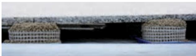
Spezielle Höhenausgleichsringe dienen als Schalung für den Mörtel. Die 27 oder 50 mm hohen Ausgleichsringe können problemlos mehrfach übereinander gesetzt werden. Damit ist der Höhenausgleich von bis zu 150 mm möglich. So lässt sich das Belagsgefälle einfach einstellen (siehe [www.gutjahr.com/techniktipps](http://www.gutjahr.com/techniktipps)).
