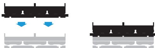
Durch Aufeinanderstapeln kann TerraMaxx® PL-H in Schritten von 28 mm aufgesteckt werden
