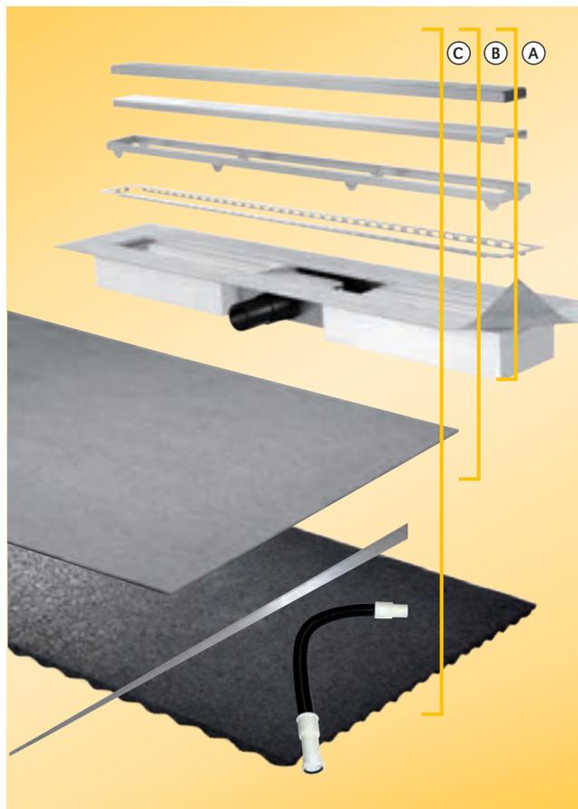
IndorTec® FLEXDRAIN-HD ist ein innovatives, ultraflaches Duschrinnen-System mit höhenverstellbarem Drainrahmen. Die einzigartige zweite Entwässerungsebene führt in die Konstruktion eindringendes Sickerwasser sicher über die Fugen in die Duschrinne ab und verhindert durch Sickerwasser-Stau verursachte Schäden.
