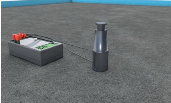
1.1 Untergrundprüfung auf Haftzugfestigkeit, Druckfestigkeit und Restfeuchtegehalt
