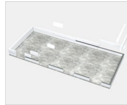
3. Montage ab der zweiten Lage in Dünnbettmörtel
