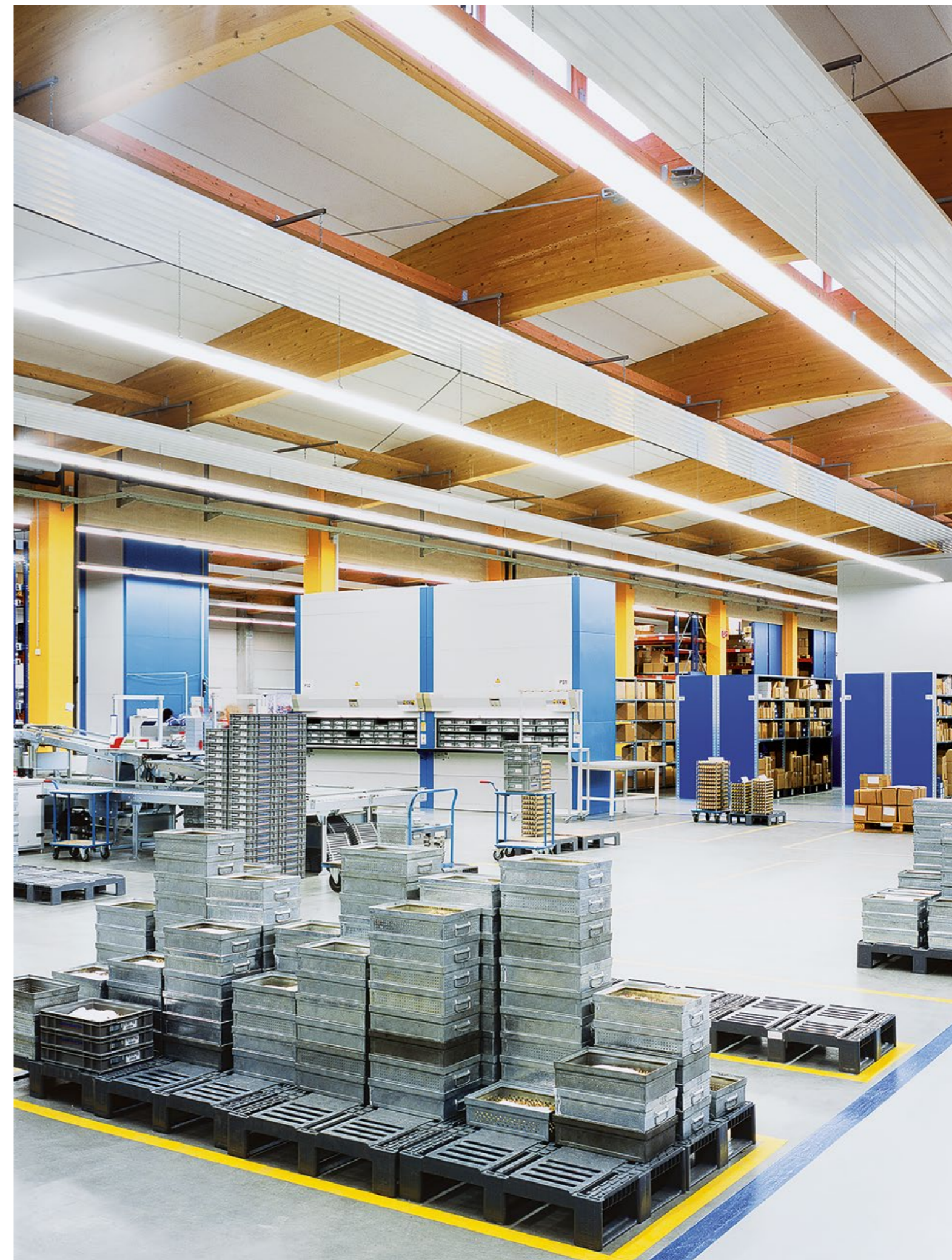
Brandsicherheit, massive Dacheindeckung, schnelle und rationelle Bauweise: Das waren die Anforderungen an das Bürogebäude mit angeschlossenem Produktionstrakt. Dank Hebel Porenbeton wurde zudem ein optimales Raumklima für die Mitarbeiter sowie für die wärme- und feuchteempfindlichen Maschinen geschaffen. Die Kühlkosten betragen in diesem Gebäude aus Hebel Porenbeton nur ca. zehn Prozent der Kosten zur Kühlung eines Leichtbaus.
