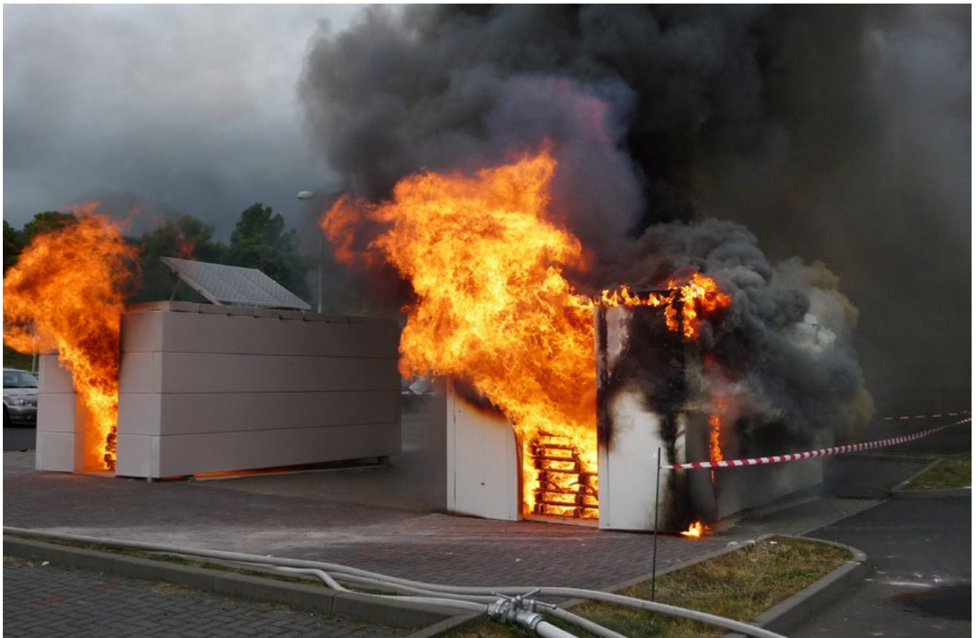
Brandversuch Hebel Porenbeton versus Metall-PUR-Sandwich-Paneeelen: Rauch und Gase treten bei Porenbeton nicht auf.
