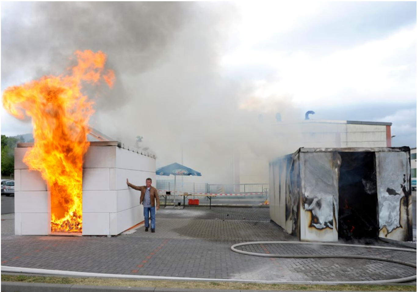
Bei Porenbeton ist die Temperaturübertragung auf die dem Feuer abgewandte Seite gering. Menschenleben und nahe der Wand gelagerte Güter bleiben geschützt.
