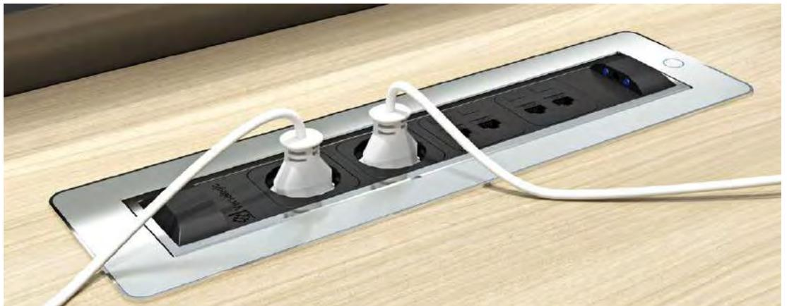
Durch Drücken der **Touch-Taste (kapazitiv)** startet VersaTURN die Drehbewegung mit Hilfe eines **Elektromotors**. Nach Abschluss der 180°-Drehung offenbart sich VersaTURN als Power & Data Moduleinheit. Um ein **Höchstmaß an Sicherheit** zu gewährleisten, ist VersaTURN mit einer **Lasersteuerung** ausgestattet, die die Schließbewegung verhindert, wenn die Stecker eingesteckt sind oder sich Hindernisse in der Nähe befinden.
