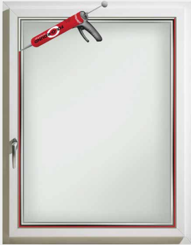
Der verbleibende Spalt zwischen Glas und Rahmen wird umlaufend mit Klebstoff ausgefüllt.
