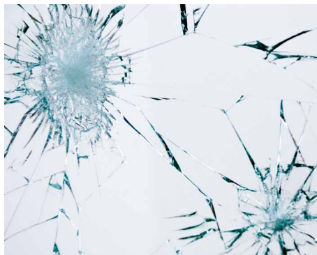
Das Verbundsicherheitsglas bricht trotz Gewalteinwirkung nicht auseinander, das Fenster bleibt geschlossen.
