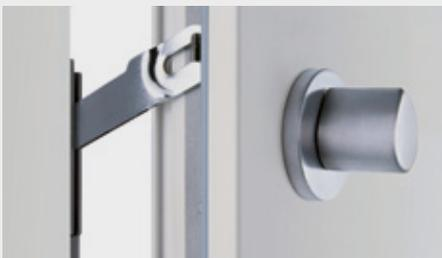
Die **Türsperre TSH** dient als Öffnungsbegrenzung. Sie wird außen über das Hauptschloss betätigt (kein Zylinder außen). Die Betätigung innen erfolgt über einen Drehknopf.
