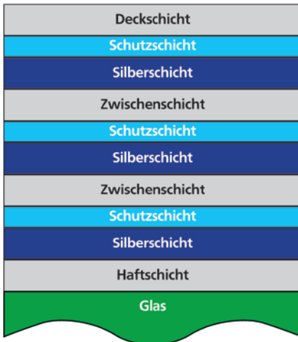
Schematische Darstellung einer 2-fach- bzw. 3-fach-Silber-Sonnenschutzbeschichtung
