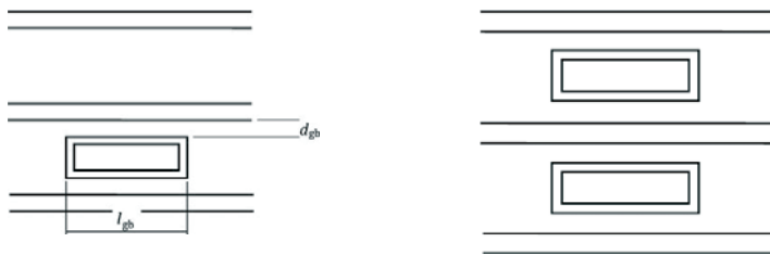
Bild G.2 — Schematische Darstellung einer in doppeltes Mehrscheiben-Isolierglas integrierten Sprosse
