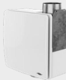
Abluftgerät zur Entlüftung von innenliegenden Feuchträumen ohne Außenfenster (DIN 18017-3). Ohne Wärmerückgewinnung. Steuerung autark. Geeignet zur Abführung der Fortluft ins Freie oder Einbindung in Abluftanlage (Geschossbau). Automatische bedarfsgeführte Luftvolumenstromregelung via Sensorik. Zulässiger Einbau im Bereich 1 in Bad- und Duschräumen nach VDE 0100.
