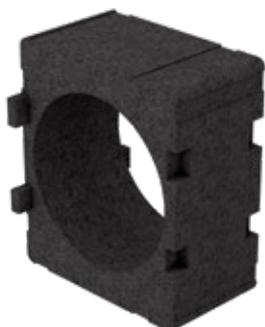
Einbauhilfe für das dezentrale Lüftungssystem iV-Smart+, iV-Light, iV-Compact, aV160 ALD Ersetzt Kernlochbohrung für die Wandeinbauhülse Ø 160 mm. Für den Neubaubereich. Integration ins Mauerwerk im Rohbau.
