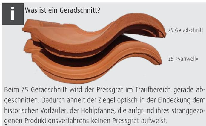
Beim Z5 Geradschnitt wird der Pressgrat im Traufbereich gerade abgeschnitten. Dadurch ähnelt der Ziegel optisch in der Eindeckung dem historischen Vorläufer, der Hohlpfanne, die aufgrund ihres stranggezogenen Produktionsverfahrens keinen Pressgrat aufweist.
