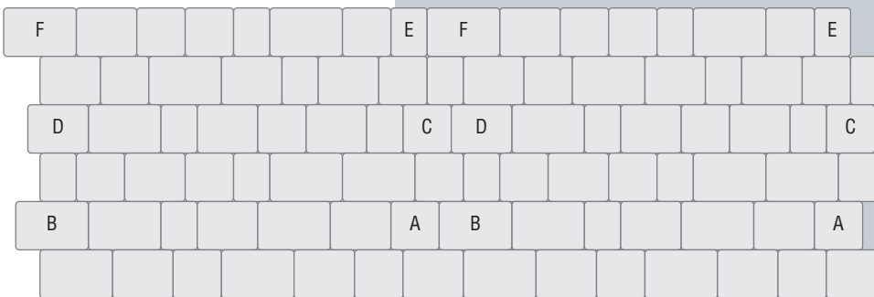
Beim Verlegen sind die Steine A mit B , C mit D sowie E mit F gegeneinander auszutauschen. Die Steine sollten aus mehreren Paketen gemischt werden!
