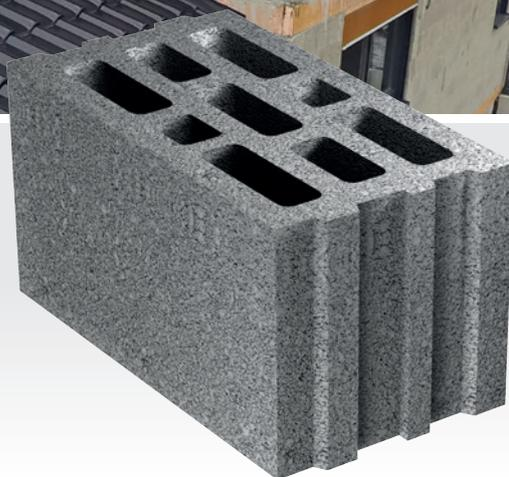
**JASTOPLAN HOHLBLÖCKE** werden überall dort eingesetzt, wo gute technische Eigenschaften gefragt sind. Die Steinfestigkeitsklassen 2, 4 und 6 decken viele statische Anforderungen ab, Rohdichten von 0,9 bis 1,2 sorgen für guten Schallschutz, die handlichen Formate bis 16 DF und eine Reihe von Ergänzungssteinen sorgen für eine problemlose Verarbeitung auf der Baustelle. Die relativ raue, offenporige Oberfläche lässt sich – im Gegensatz zu glatten Steinen – ohne Vorbehandlung verputzen.
