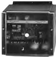
Elektronikplatinensteuerungen zum niveauabhängigen Betrieb von einer oder mehrerer Pumpen im Direkt- oder Sterndreieck-Start.
