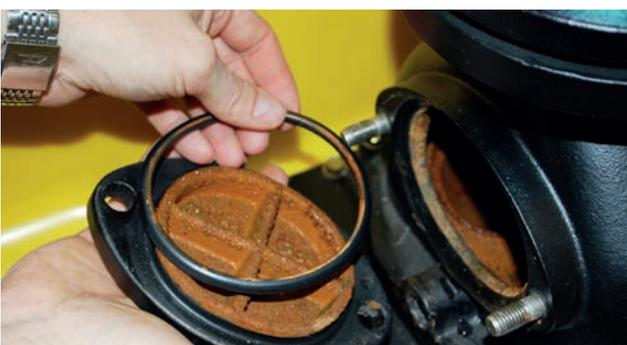
▶ Prüfung und Reinigung der Rückschlagklappe
