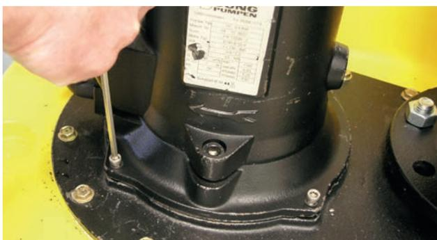
▶ Einfaches Lösen der Pumpeinheit
