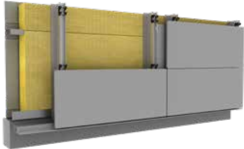
FC HORIZONTAL AUF STAHLKASSETTE
