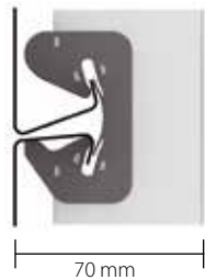
Systemtiefe mit Rasterklickschiene SE
