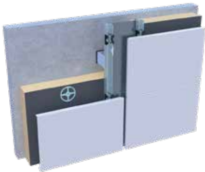
FC HORIZONTAL AUF MASSIVWAND (SEL)
