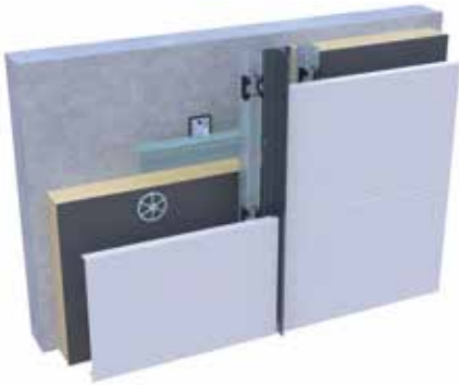
FC HORIZONTAL AUF MASSIVWAND (SE)
