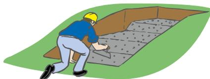
Eine Grob-schalung aus Brettern und Pfosten nach den Anforderungen (Höhen) der späteren Stufenanlage erstellen. Achten Sie beim Bau der Schalung auf
