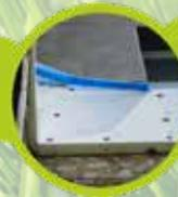
Dämmplatten aus Rückbau
