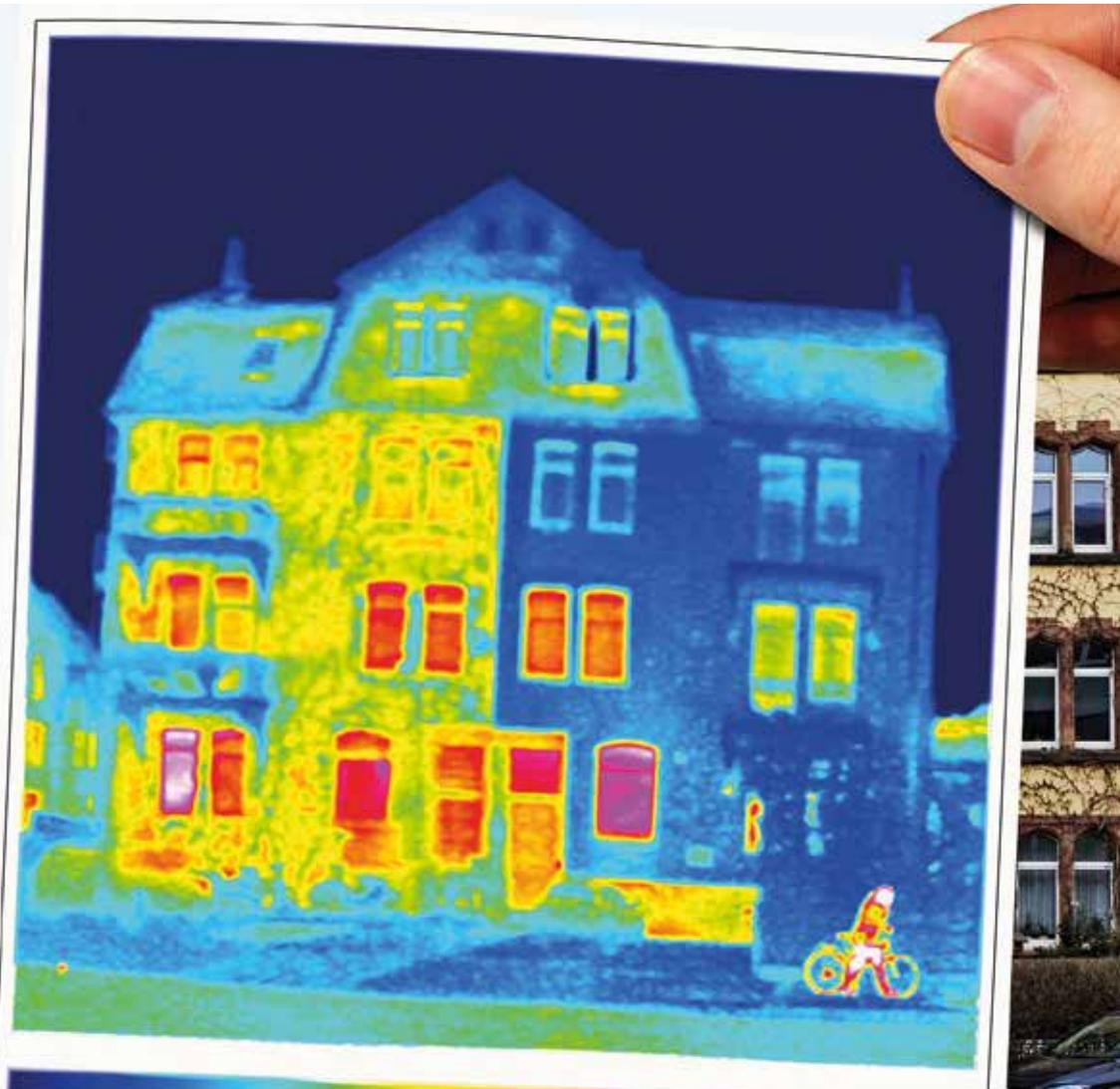
Professionelle Wärmedämmstoffe und deren fachgerechte Verarbeitung bewirken eine effiziente Ressourcenschonung mit einhergehender Minimierung des CO<sub>2</sub>-Ausstoßes, die Vermeidung von Bauschäden wie Feuchtigkeit und Schimmelbildung, die Verbesserung des Raumklimas, eine Wertsteigerung der Immobilie und die Erfüllung der gesetzlichen Auflagen (Energieeinsparverordnung).
