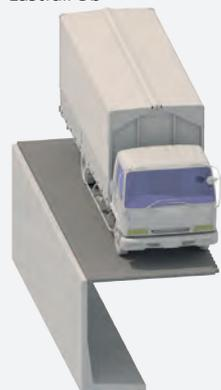
Verfüllung hinter der Mauer-scheibe; ebenes Gelände. Die gewonnene Fläche ist mit Schwerlastverkehr bis max. 60to befahrbar.
