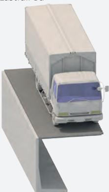
Verfüllung hinter der Mauer-scheibe; ebenes Gelände. Die gewonnene Fläche ist mit Schwerlastverkehr bis max. 30to befahrbar.
