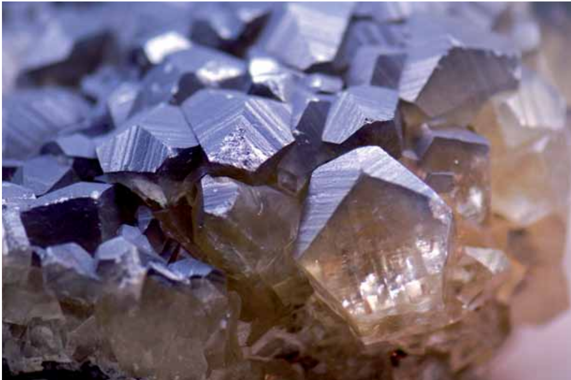
Quarz – der Grundstoff für das silikatische Bindemittel „Wasserglas“ oder „Kaliumsilikat“
