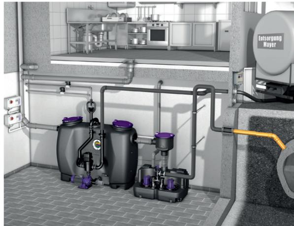
Aqualift F XL ist die leistungsstarke Hebeanlage für den gewerblichen, industriellen und kommunalen Bereich. Zum Beispiel zum Heben von Regenwasser, das unterhalb der Rückstauenebene anfällt. Außerdem ist sie für den Einsatz hinter Abscheidern optimal geeignet. Alle Komponenten – wie Behälter und Pumpen – sind als Baukastensystem konzipiert.
