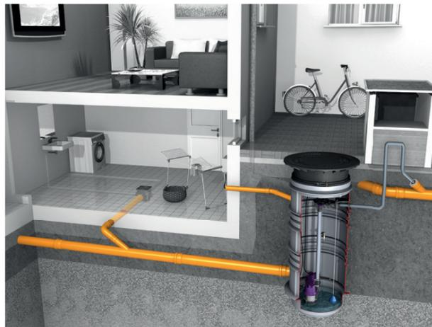
Die Pumpstation *Aqualift S* lässt sich für die Entwässerung von fäkalienfreiem Abwasser unterhalb der Rückstauenebene, zur Rückstausicherung von Abscheideranlagen und zur Entwässerung von Drainageleitungen einsetzen. Sie besteht aus einem Standard-Schacht LW 600 und einer integrierten Pumpe für Schmutz- und Regenwasser und ist grundwasserbeständig bis 2500 mm.
