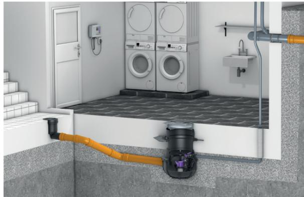
Die Hebeanlage *Aqualift S* entsorgt zuverlässig und hygienisch fäkalienfreies Abwasser über eine Druckleitung in den Kanal. Sie ist sowohl mit Schwimmersteuerung als auch mit Sondensteuerung erhältlich. Das dreh-, neig- und höhenverstellbare Aufsatzstück ermöglicht beim Einbau einen stufenlosen Höhen- und Niveausgleich und eine Anpassung an das Fliesenraster.
