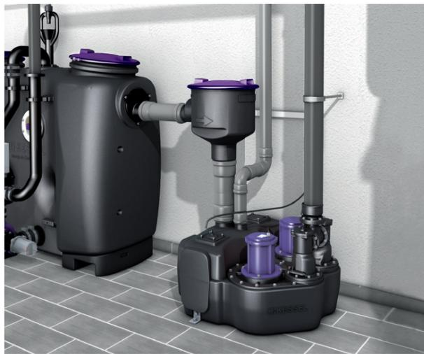
Aqualift F ist die klassische Lösung zur Entsorgung von häuslichem Abwasser. Die Monoanlage ist mit einer Pumpe ausgestattet, die Duoanlage besitzt eine zweite Pumpe und wird dort eingesetzt, wo es zu keiner Betriebsunterbrechung durch Pumpenausfall kommen darf. Die Hebeanlage fördert das anfallende Abwasser sicher und vollautomatisch durch die Druckleitung über die Rückstauschleife zum Kanal.
