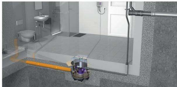
Die Hebeanlage *Aqualift F Compact* übernimmt die komplette Kellerentwässerung. Sie fördert das Abwasser sicher und vollautomatisch über die Rückstauenebene in die höher liegende Kanalisation. Auch bei Rohrbruch oder Hochwasser – dank integrierter Ablauffunktion. Mit ihren kompakten Maßen kann sie leicht eingebaut oder frei aufgestellt werden.
