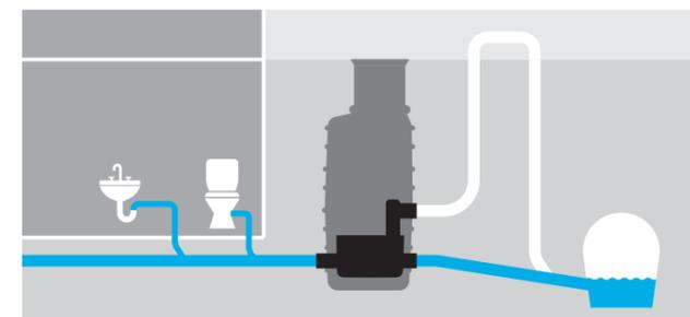
Hybrid-Hebeanlagen nutzen das natürliche Gefälle zum Kanal.
