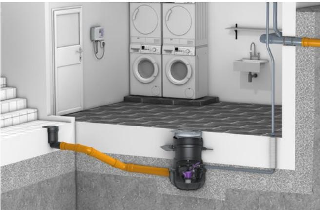
Die Hebeanlage *Aqualift S* entsorgt zuverlässig und hygienisch fäkalienfreies Abwasser über eine Druckleitung in den Kanal. Sie ist sowohl mit Schwimmersteuerung als auch mit Sondensteuerung erhältlich. Das dreh-, neig- und höhenverstellbare Aufsatzstück ermöglicht beim Einbau einen stufenlosen Höhen- und Niveaugleich und eine Anpassung an das Fliesenraster.
