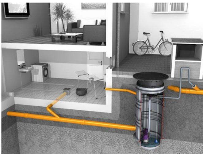
Die Pumpstation *Aqualift S* lässt sich für die Entwässerung von fäkalienfreiem Abwasser unterhalb der Rückstauenebene, zur Rückstausicherung von Abscheideranlagen und zur Entwässerung von Drainageleitungen einsetzen. Sie besteht aus einem Standard-Schacht LW 600 und einer integrierten Pumpe für Schmutz- und Regenwasser und ist grundwasserbeständig bis 2500 mm.
