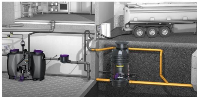
Mit *Ecolift XL* bieten wir eine Hybrid-Hebeanlage speziell für den Einsatz in gewerblich genutzten Gebäuden und Mehrfamilienhäusern mit natürlichem Gefälle zum Kanal. *Ecolift XL* nutzt im Normalbetrieb das natürliche Gefälle und pumpt das Abwasser nur bei Rückstau – mit Pumpenleistungen von 1,5 bis 4,5 Kilowatt.
