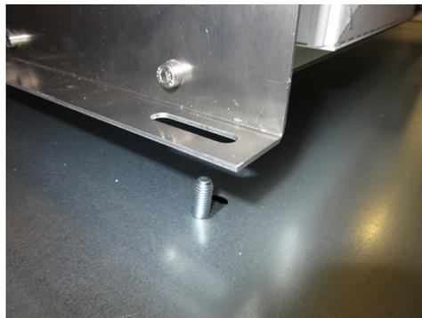
6. Die beiden Scharniere können zur Verringerung des Spaltes ausgerichtet bzw. nachgestellt werden. Hierfür sind die Muttern M8 geringfügig zu lösen.
