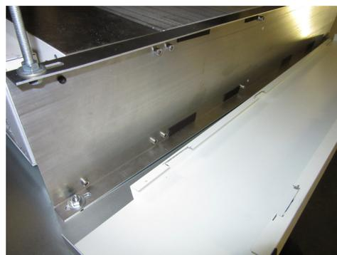
2. In die vier Langlöcher an der Oberseite der Sekundärluftkühleinheit sind Gewindestangen M8 einzuführen und mit Unterlagscheibe und Mutter M8 zu sichern.
