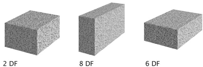
KLB-Plan-Vollsteine sind kleinformatige, massive Ergänzungssteine, die wärmetechnisch den KLB-Plan-Blöcken angepasst sind. Die Steine haben eine Höhe von 12,4 mm und eine Länge von 249 mm. Die Stirnseiten sind im Gegensatz zu KLB-Plan-Blöcken mit der Vollverzahnung in der Stoßfuge, glatt und müssen daher in Lager- und Stoßfugen vermörtelt werden.
