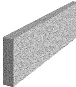
KLB-Wandbauplatten der Abmessung 99,0 x 6,0 x 32,0 cm werden grundsätzlich für nichttragende, leichte Trennwände eingesetzt. Sie können mit einem pauschalen Zuschlag zur Verkehrslast der Decken berücksichtigt werden.
