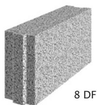
KLB-Hohlwandplatten können neben 8 DF-Vollsteinen als leichte Trennwandsteine für nichttragende Wände, Abmauerungen oder Ummauerungen eingesetzt werden. KLB-Hohlwandplatten haben die gleiche Stoßfugenverzahnung wie die Plan-Hohlwandplatten. Die Lagerfuge wird bei den Hohlwandplatten im Dickbettverfahren ausgebildet, die Stoßfuge bleibt mörtelfrei.
