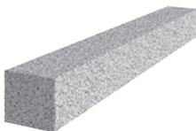
KLB-Flachstürze bestehen aus einem vorgefertigten, leicht bewehrten Zuggurt und erlangen erst mit einer Druckzone aus Mauerwerk oder Beton ihre Tragfähigkeit. Die Druckzone ist aus Vollstein-Mauerwerk,  $SFK \geq 2 \text{ N/mm}^2$ , im Verband mit vollständig gefüllten Stoß- und Lagerfugen  $\geq \text{MG IIa}$  herzustellen.
