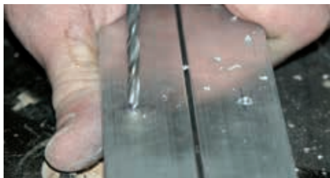
Bohren des Rahmens.
