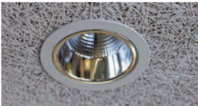
Spotlights bis DA = 300 mm ab Plattendicke 15 mm, max Gewicht \leq 1,0 kg Downlights bis DA = 300 mm ab Plattendicke 25 mm, max Gewicht \leq 3,0 kg Downlights bis DA = 300 mm ab Plattendicke 35 mm, max Gewicht \leq 6,0 kg
